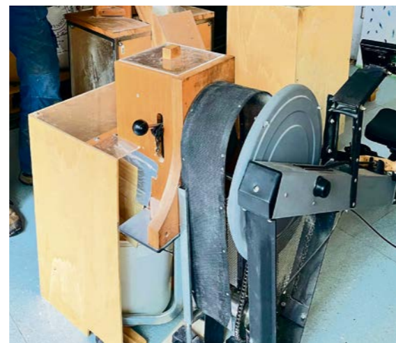
Die Secondhand-Fitnessgeräte hat Tom Wieland zusammen mit einem Kollegen zu Produktionsmaschinen mit integrierten Mühlen umgebaut.
